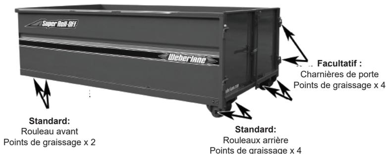
Si votre remorque est équipée de ces graisseurs, veillez à les lubrifier régulièrement avec une graisse à haute teneur en lithium. Ces points de graissage viennent s'ajouter au graissage standard des composants de l'essieu, comme indiqué ailleurs dans ce manuel.
